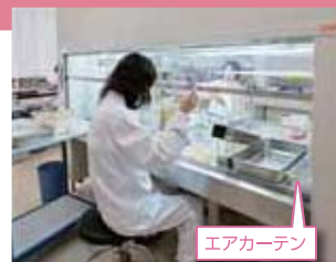
エアカーテンで仕切られた無菌状態の空間で正確に測定・検査
